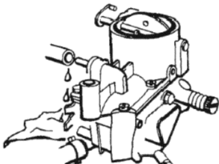
Рисунок E Отсоедините топливную трубку от карбюратора и проверьте подачу топлива
