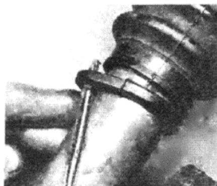
Фото 3.8. Установка сильфона приводного вала и крепежного кольца
