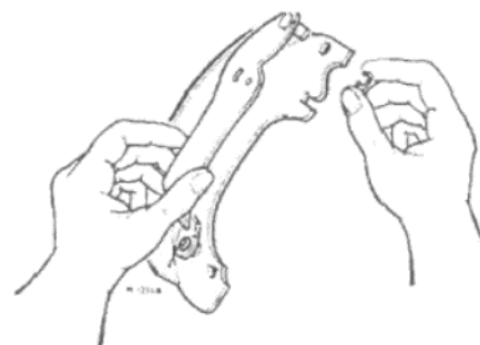
Рисунок 10.14. Снятие пружинного зажима и рычага регулятора (Раздел 7)
