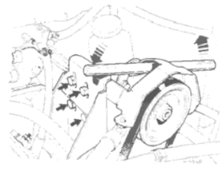
Рисунок 13.25. Натяжение приводного ремня усилителя рулевого управления. Крепежные болты насоса (указаны стрелками) (Раздел 9)
