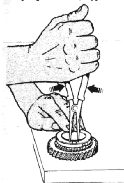
Рисунок 6.3. Снятие крепежного пружинного зажима синхронизатора (Раздел 6)
