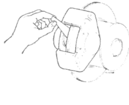
Рисунок 10.2. Проверка положения поршня на суппорте Teves (Раздел 2)
