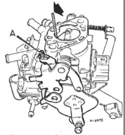
Рисунок 3.6. Регулировка зазора быстрых холостых оборотов – карбюраторы Solex. Стрелка указывает на шпильку диаметром 1 мм (Раздел 6)
